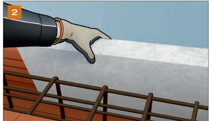
2 Bewehrung einlegen und fixieren. Außenliegende Seite mit Wärmedämmung versehen.
