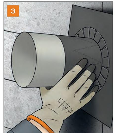
Über den Dreieckstreifen einen zusätzlichen länglichen Streifen kleben. An den Längsseiten ca. 2 bis 3 cm tief einschneiden und an Wand und Rohr kräftig andrücken.
