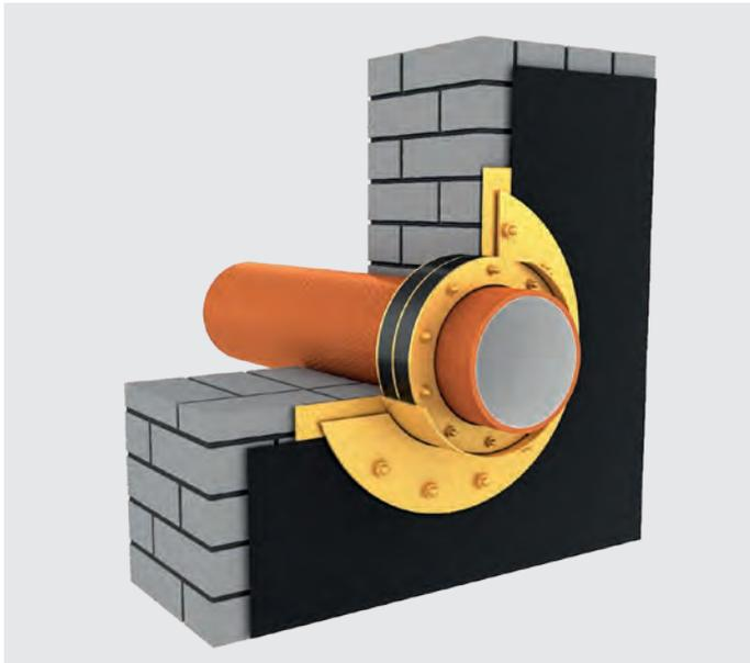
Durchdringungen bei der Wassereinwirkungsklasse W2-E müssen mit einer Los- und Festflanschkonstruktion ausgeführt werden. Bei mäßiger Einwirkung von drückendem Wasser können Anschlüsse an Durchdringungen auch mit geprüften Hauseinführungssystemen ausgeführt werden.
