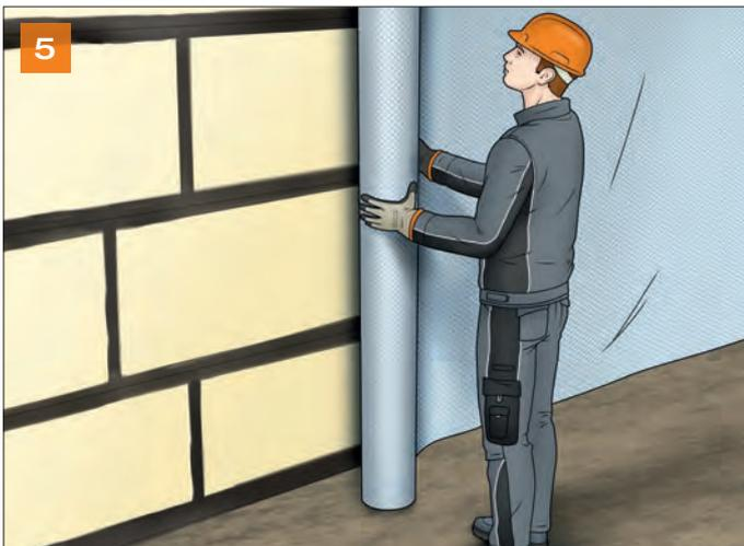
Noppenbahn vor die Dämmplatten spannen. Sie soll die Platten vor mechanischen Schäden schützen, wie sie entstehen, wenn beispielsweise spitze Steine oder auch Wurzelwerk dagegen drücken. Die Noppenbahn schützt jedoch nicht vor Feuchtigkeit! Arbeitsraum ohne Beschädigung der Schutzschicht mit nicht bindigem Material verfüllen.
