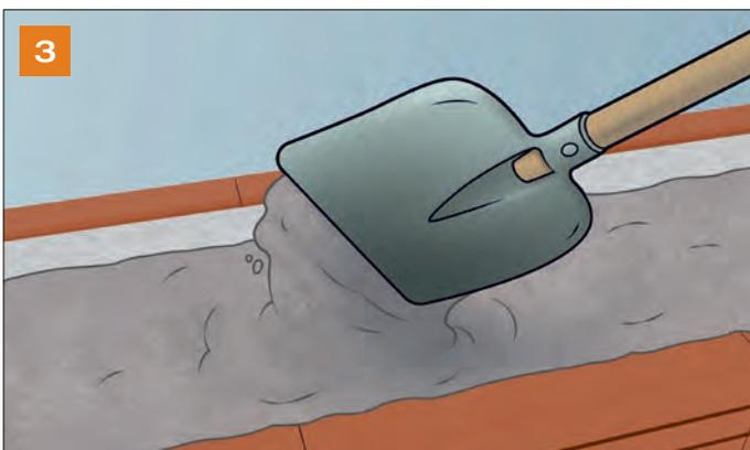
3 Gegebenenfalls Sparrenaufleger für Dachstuhl montieren und U-Schale ausbetonieren.
