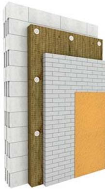
zweischaliges Mauerwerk, Außenschale verputzt oder als Sichtmauerwerk, mit Wärmedämmung
