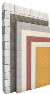
einschaliges Mauerwerk mit einem zusätzlich aufgebracht WDVS
