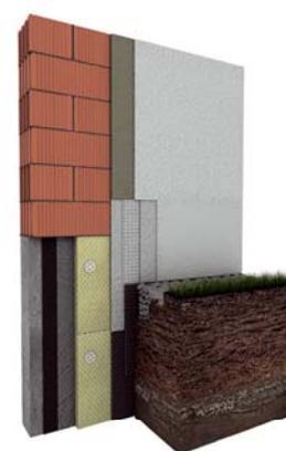
einschaliges Kellermauerwerk mit oder ohne Perimeterdämmung
