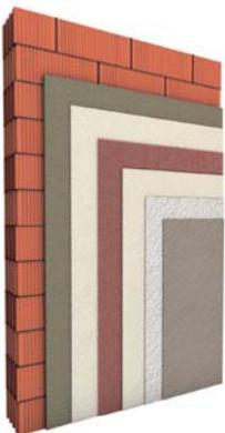
einschaliges Mauerwerk aus hoch wärmedämmenden Wandbaustoffen mit einem Putzsystem
