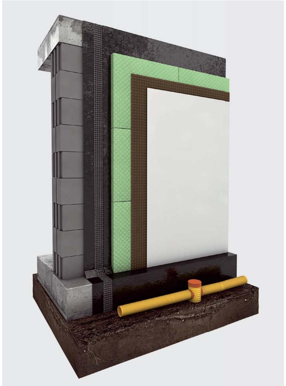
Bei sachgerechter, lagenweiser Verfüllung der Baugrube muss sichergestellt werden, dass die Schutzschicht nicht beschädigt wird und keine erhöhten Lasten auf die Abdichtung einwirken. Wenn die Schutzschicht mit der Abdichtung verbunden (verklebt) ist, darf beim Anfüllen und Verdichten des Erdreiches die Schutzschicht nicht bewegt werden.
